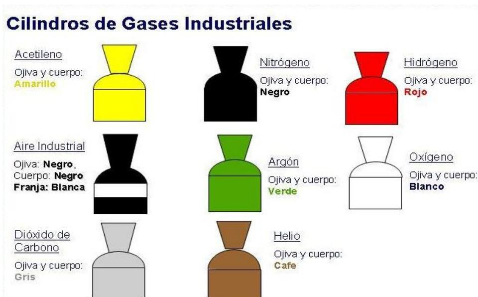
**Figura 2.** Identificación por color de gases industriales.
